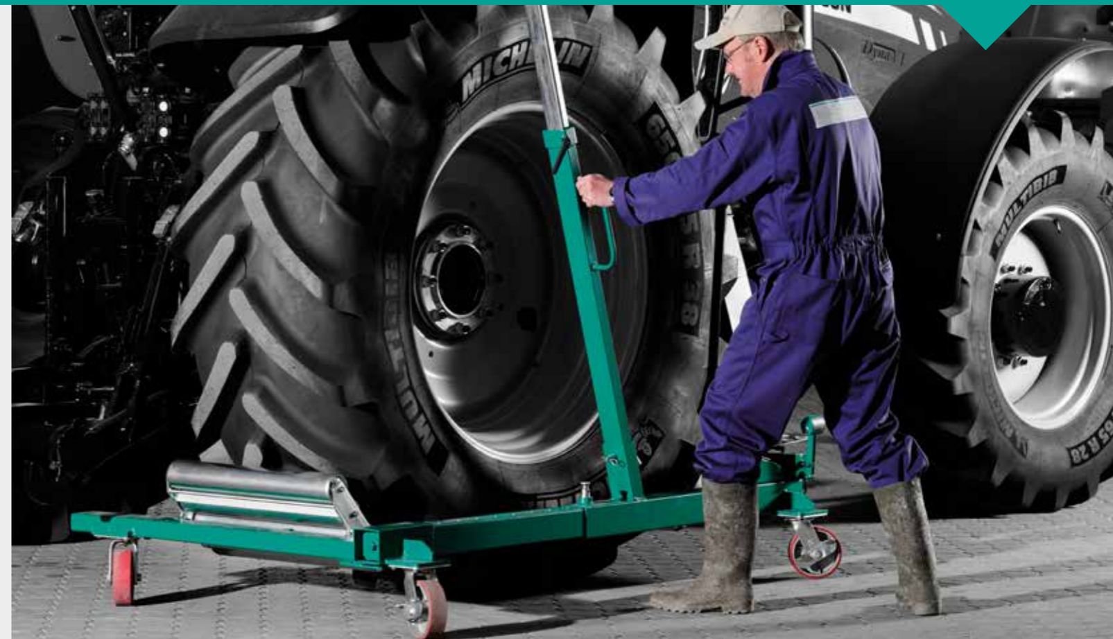
Geschikt voor grote wielen met een diameter van 1250 mm tot 2400 mm en een diepte van maximaal 1050 mm.
